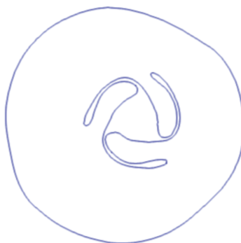
Рис. 10. Поперечное сечение баллона по сравнению с нераскрытой конфигурацией
