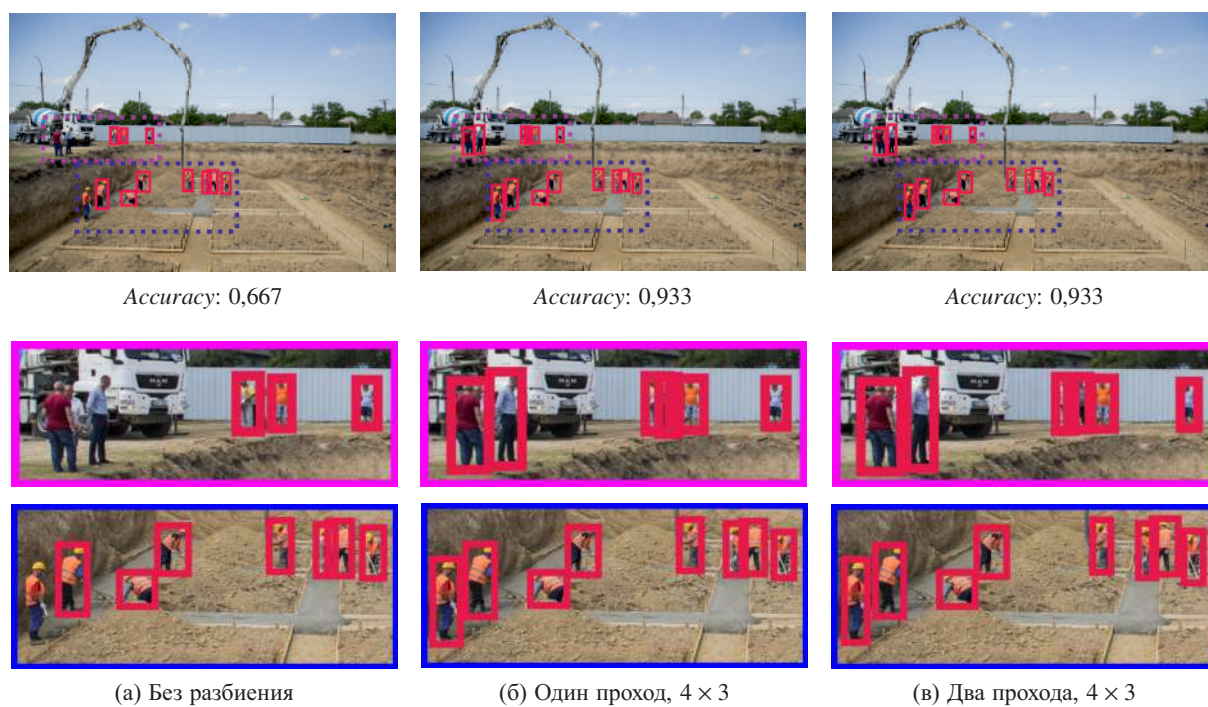
Рис. 11. Результаты детекции для (а) однопроходного алгоритма без разбиения входного изображения, (б) однопроходного алгоритма с равномерным разбиением 4 \times 3 и (в) двухпроходного алгоритма с подбором оптимального разбиения (с разбиением 4 \times 3 для первого прохода). В качестве детектора использовалась модель FSSD512 , изображение взято из тестовой части датасета. По вертикали — основное изображение и некоторые увеличенные его части (выделены пунктиром на основном изображении)
