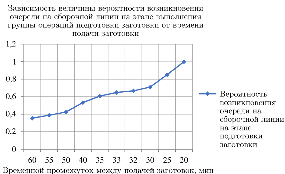
Рис. 6. Зависимость величины вероятности возникновения очереди на сборочной линии на этапе выполнения группы операций подготовки заготовки от времени подачи заготовки
